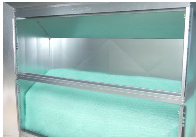
Überstehendes Material an den Rändern Umschlagen bzw. nach Innen stopfen. Bild zeigt den Stützkorb mit eingebauten Filtermatten.
