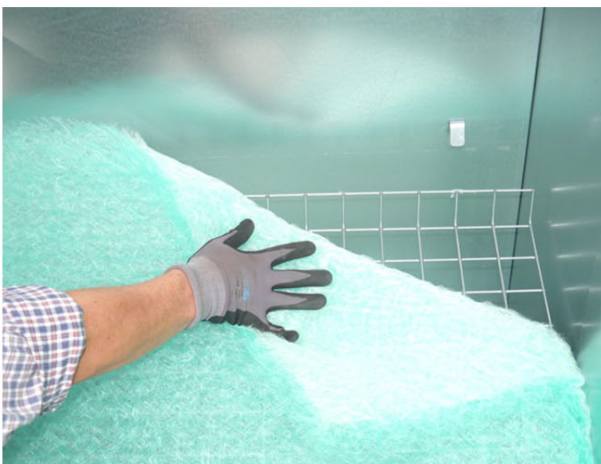
Filtermatte einsetzen – Draht-Stützkorb nach unten drücken. Filtermatten um den Rand schlagen und Stützkorb wieder in den Halterungen befestigen.
