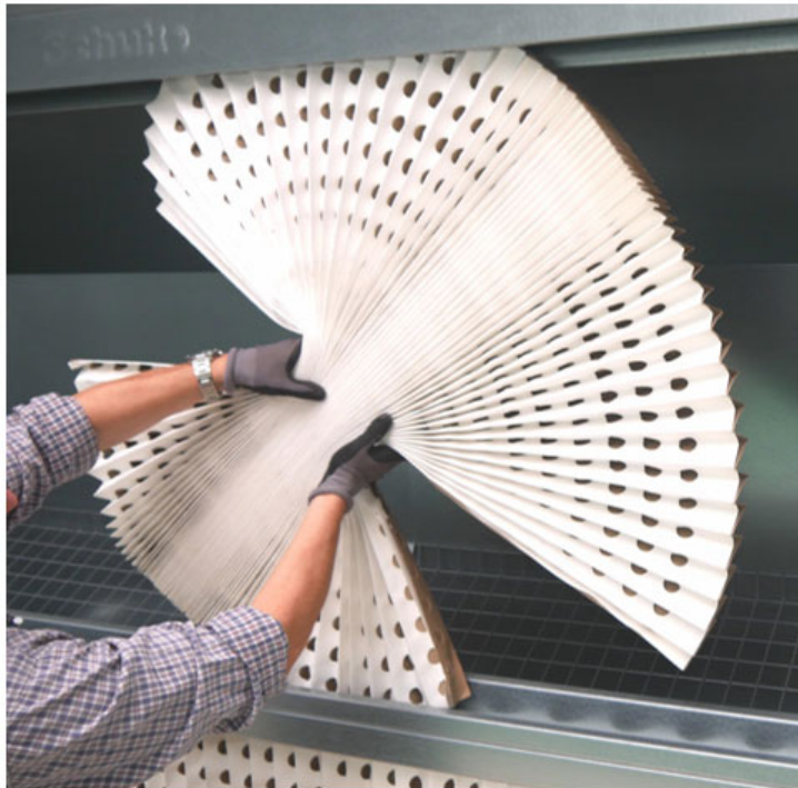
Bild rechts: Kartonfilter in der Mitte zusammendrücken, um 90 Grad drehen und entnehmen bzw. einsetzen.
